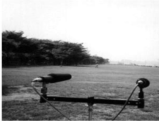
그림) 스테레오 바를 활용한 마이크 설치 (사진 크기조정은 자유롭게 여백에 맞게 편집요)
